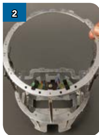
2 Установите кольцо на каркас так, как показано на фотографии: чтобы отверстия деталей совпадали.
